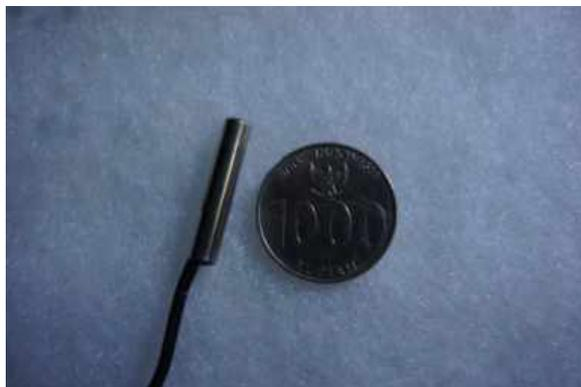
Gambar 1. Bentuk fisik sensor NTC tipe W1209 10k
