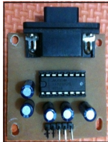
Gambar 2.5. Realisasi Rangkaian Pengubah Tegangan TTL ke RS232 Menggunakan IC MAX232
