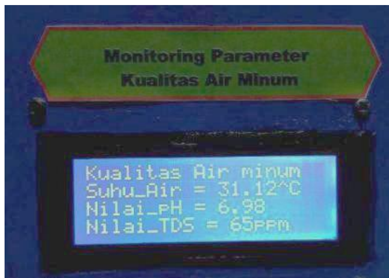
Gambar 13. Tampilan monitoring kualitas air minum secara offline dengan LCD 20x4
