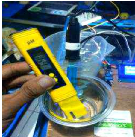
Gambar 16. Proses kalibrasi pH meter dengan Buffer Solution Powder
