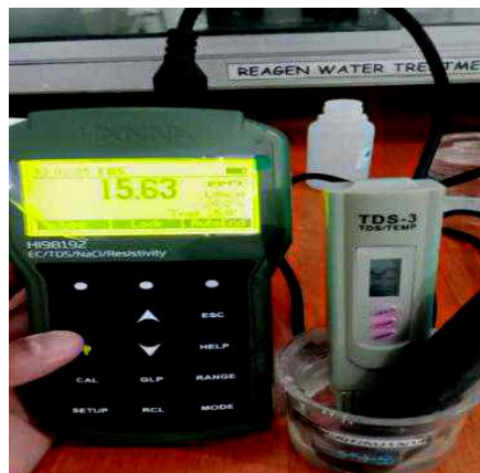
Gambar 15. Proses kalibrasi TDS meter dengan TDS meter pada laboratorium water treatment
