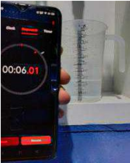
Gambar 9. Proses pengukuran debit air dan perhitungan waktu pengisian
